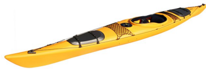
seekajak - hochgezogene bootspitze ermöglicht trockene fahrweise
